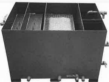
油水分離の困難なコンプレッサードレン廃水等を動力を使わずに油水分離槽内で比重差分離法、造粒法及び吸着法の組み合わせによって、油水分離処理することができ、排水規制値をクリアし、取扱いが簡単でランニングコストのかからない、経済性に優れた、精密油水分離槽。
