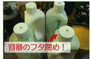
フタ開放で8時間に60gの溶剤が蒸発します。 (日本印刷産業連合会 印刷産業におけるVOC排出抑制自主的取組推進マニュアルより)
