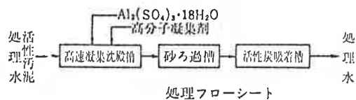
図－3 ビール工場に於ける高度処理例 3)
