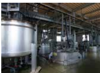
ニッケル、コバルトの 金属化合物を製造する 反応容器
